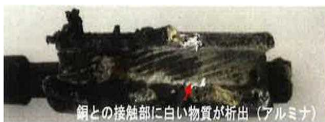
電線接続箇所拡大図
